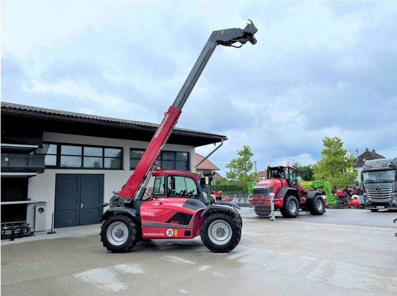
Weidemann T7035 mit 3,5t Hubkraft, 7m Hubhöhe, 4 Zylinder Perkins Motor, kompakte wendige Maschine, ca 7200kg Eigengewicht, Hydrostatischer Fahrtrieb, 102 PS (Optional 122 PS / 136 PS möglich)
