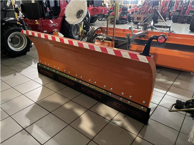
Bema Schneeschild 700/2050mm breit, hydraulisch Schwenkbar, Schwerlastlaufräder, Beleuchtungsanlage lt STVZO ( 1x DW, 1x E Anschluss notwendig für die Beleuchtung), großer Rollniveaueausgleich, Gummi-Korund-Schürfleiste mit Federklappensegmente,
