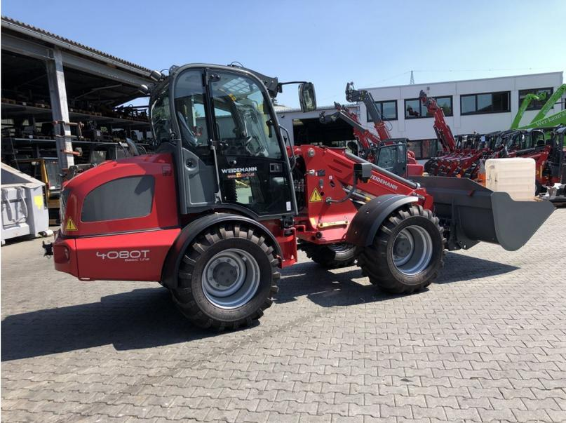
Weidemann 4080 T Basic Line mit Beleuchtungsanlage, 100% Differentialsperre, 4 Zylinder Motor, verschiedenste Aufnahmen erhältlich (z.B Euro & Weidemann), ca. 5070mm Hubhöhe.
