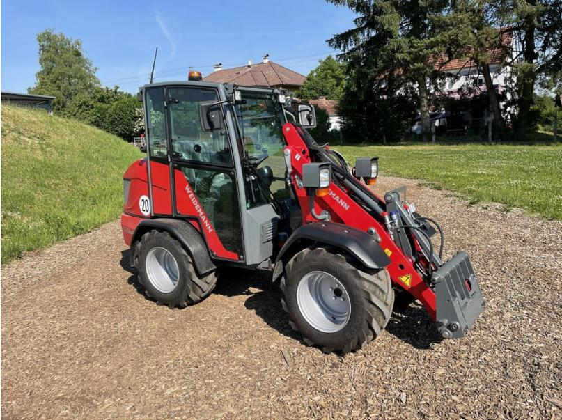
Der neue Weidemann 1260LP mit einer Bauhöhe unter 2m, 20km/h serienmäßig, Kabinen- oder Fahrerschutzdach Variante verfügbar, kein Dieselpartikelfilter oder Ad-Blue, 2 starke Hubzylinder, 3 verschiedene Hubhöhen möglich ... und vieles mehr im Video bzw. auf Anfrage
