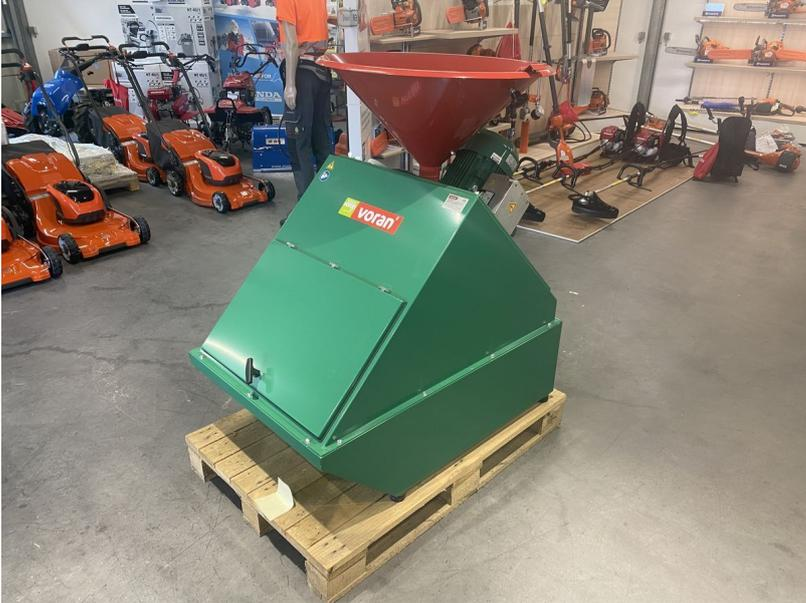
Die Hammermühle ist ein Ausstellungsstück ausgestattet mit 1 Schlägler. Die Leistung mit Hafer (Sieb 3mm) beträgt 380kg/h, die Leistung mit Mischgetreide (Sieb 3mm) beträgt 540kg/h. Sie hat eine Motorleistung von 5,5kW/7,5PS. Für den Anschluss benötigt sie einen elektrischer Anschluß mit 400V und 50Hz (dreifasig). Sie ist mit 16 A elektrisch Abgesichert. Die ungefähren Abmasse betragen: 115cm x 72cm x 132cm (L/B/H).
