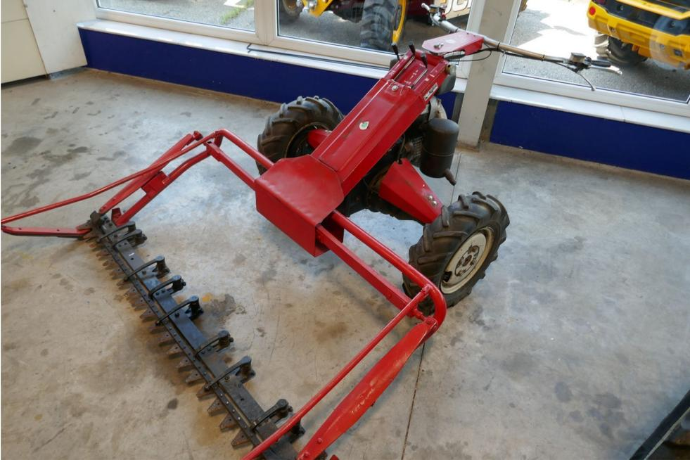
Vogel&Noot Jet II, Breitspurmotormäher, mit Gummibereifung und Spatenräder, 1,60 m Doppelmessermähwerk, 2-Takt-Motor, Wendegetriebe mit Lenkbremse, einsatzbereit, Werkstatt-kontrolliert, Standort Lieserbrücke, prompt verfügbar.
