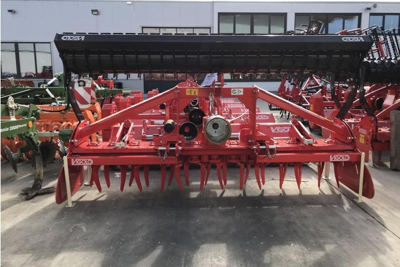
Vigolo EN-Plus 300 mit Packerwalze, Einstufengetriebe, 540 U/Min, mechanische Höhenverstellung der Walze, Planierschiene, Gelenkwelle.
