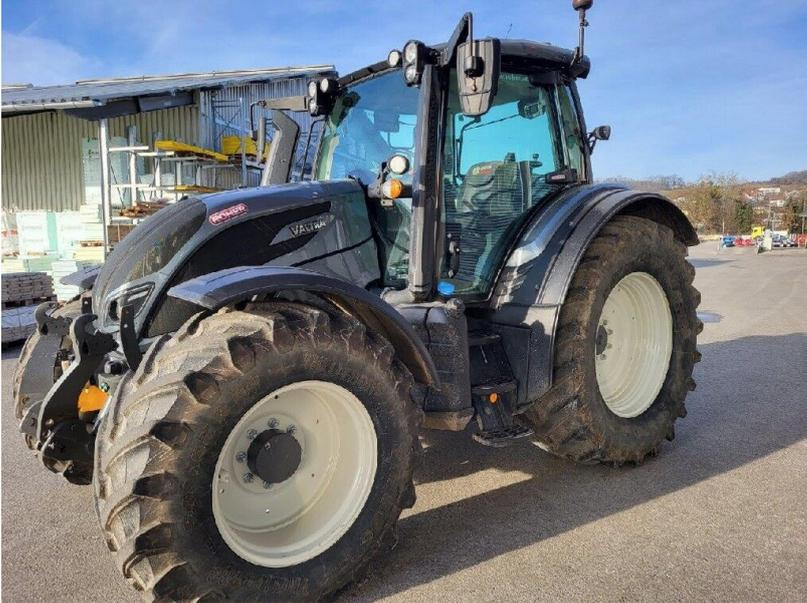
Klimaanlage, EHR, FH & FZW, Stufelos Getriebe, Druckluftanlage, 50km/H; gef. Vorderachse, 540/750/1000upm, Scheibenwischer rechts seitlich, 8 Scheinwerfer, Zusatzmonitor, K80, ISOBUS, 2 Rundumleuchten, 2DW vorne, ABS, Streckbremse, Panoramadach, Heckscheibenwischer, elektr. Spiegel, Handyhalterung, Kreuzhebel elektr.
