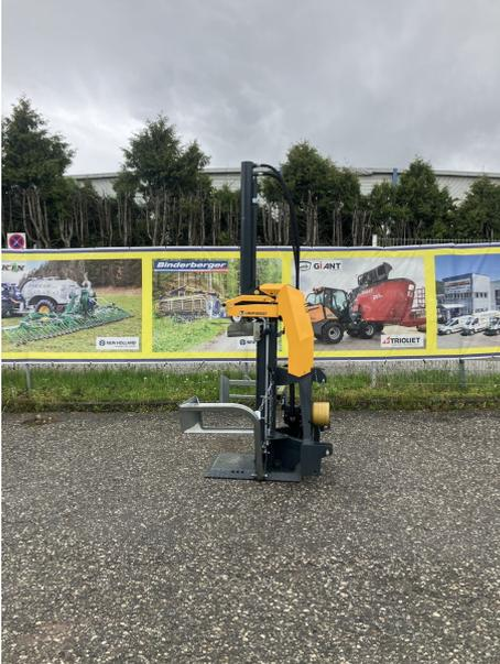
Uniforest Meterholzspalter auf 3-punkt Anbau mit Zapfwellenantrieb, 16t Spalkraft, Spalllänge 115cm, Gewicht 370kg, Stammheber (mechanisch), ohne Gelenkwelle, neuwertiger Zustand, sofort verfügbar.
