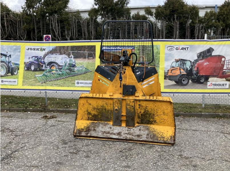
UNIFOREST 85 H, 8,5 t Funkseilwinde mit oberer und unterer Seileinlaufrolle, Seilausstoß, Seil mit Parallelhaken, Seilgleiter, Motorsägenhalter, Sapinhalter, Schildbreite: 200 cm, Schutzgitter, sofort verfügbar.
