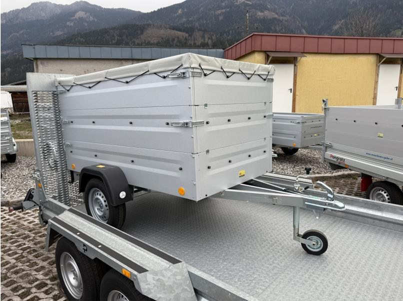
Robuster ungebremster Tieflader mit verzinkter V-Deichsel und widerstandsfähigem Aufbau mit Alu-Zink-Beschichtung.
