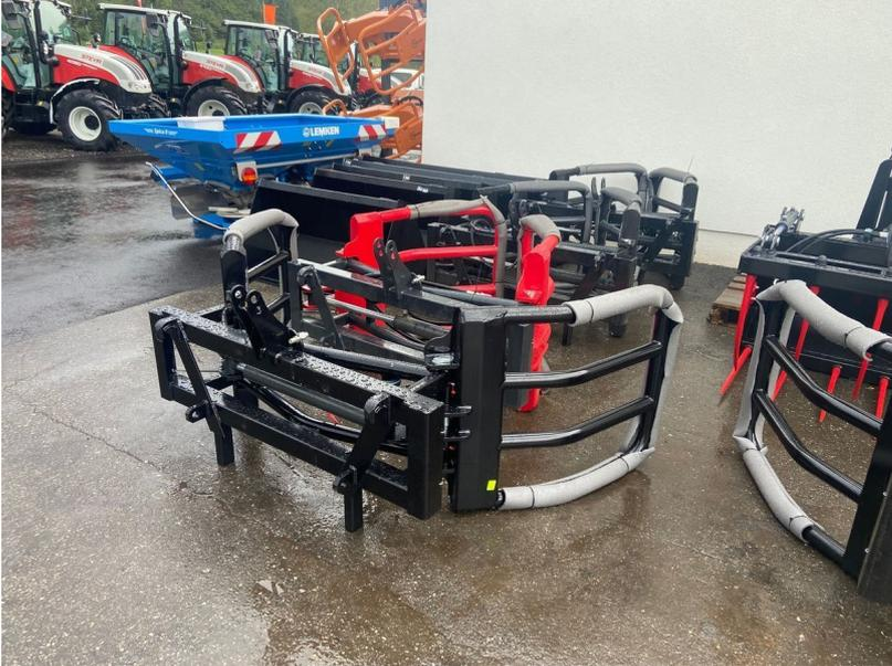
Stekro Rundballengreifer mit einem Zylinder. Euro und Dreipunktaufnahme.
