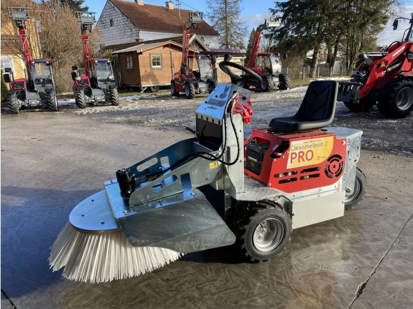
Westermann Cleanmeleon 2 Honda PRO - mit E-Start, 13 PS, mit Hydraulik (6,0 l / min., 18 ltr. / min Fördervolumen), mit hydraulischer Aushebung (inkl. Schwimmstellung), mit Set Kontergewicht, Radialbesen R1000 + Abstreifbleche, sehr kraftvolles, wendiges Arbeiten, verbesserte Schwerpunktverlagerung, erhöhte Hubkraft, einsatzbereit für Arbeiten unter hoher Beanspruchung, schnelles, werkzeugloses Wechseln der Anbauköpfe, L = 1500 mm, B = 825 mm, H = 1130 mm.
