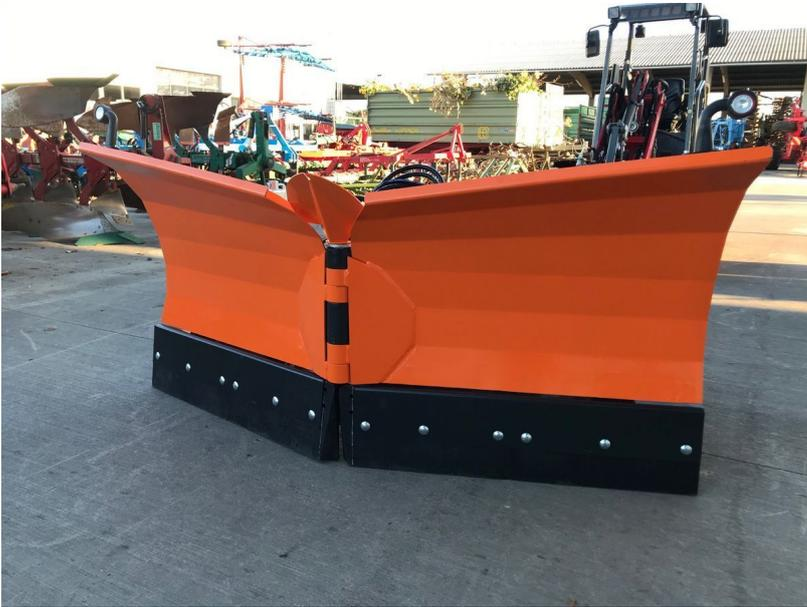
Vario-Schneeschild mit starker Gummischürfleiste, Federklappensegeln, Hochwertigem Stahl, Hydraulische schwenkbar Rechts & Links, Höhe des Schilds 0,88m, mit Beleuchtungsanlage, Optional mit Reifen & Schürfleiste, Serienmäßig mit Kufen, Aufnahme mit Höhenausgleich.
