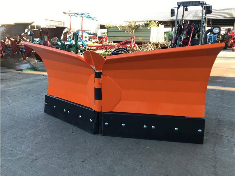
Vario-Schneeschild mit starker Gummischürfleiste, Federklappensegmenten, Hochwertigem Stahl, Hydraulisch schwenkbar Rechts & Links, Höhe des Schilds 0,88m, mit Beleuchtungsanlage, Optional mit Reifen & Schürfleiste, Serienmäßig mit Kufen, Aufnahme mit Höhenausgleich.
