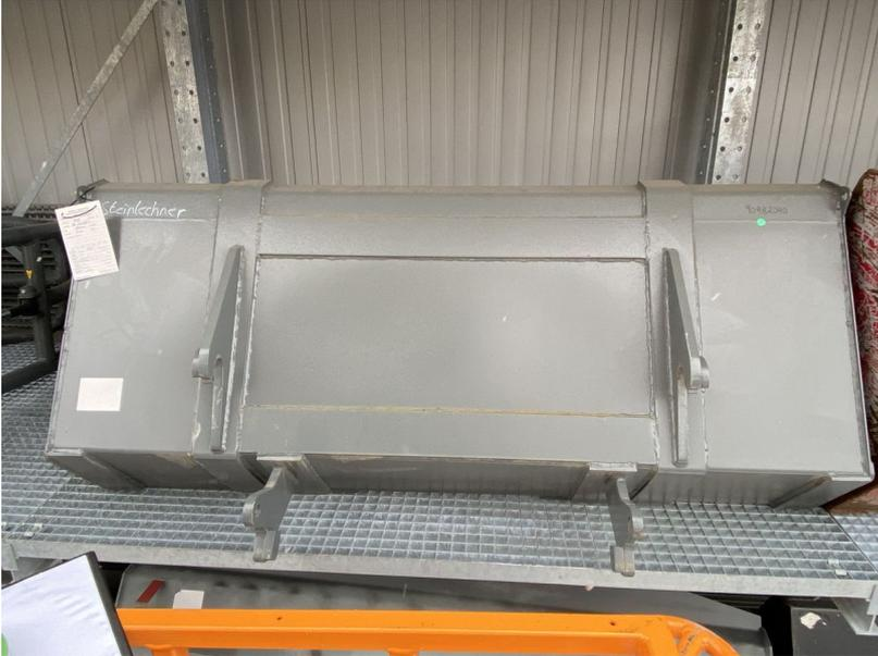
Schaufel 1800mm mit Euro Aufnahme mit versetztem Anbau, 30cm tiefer, Volumschaufel.
