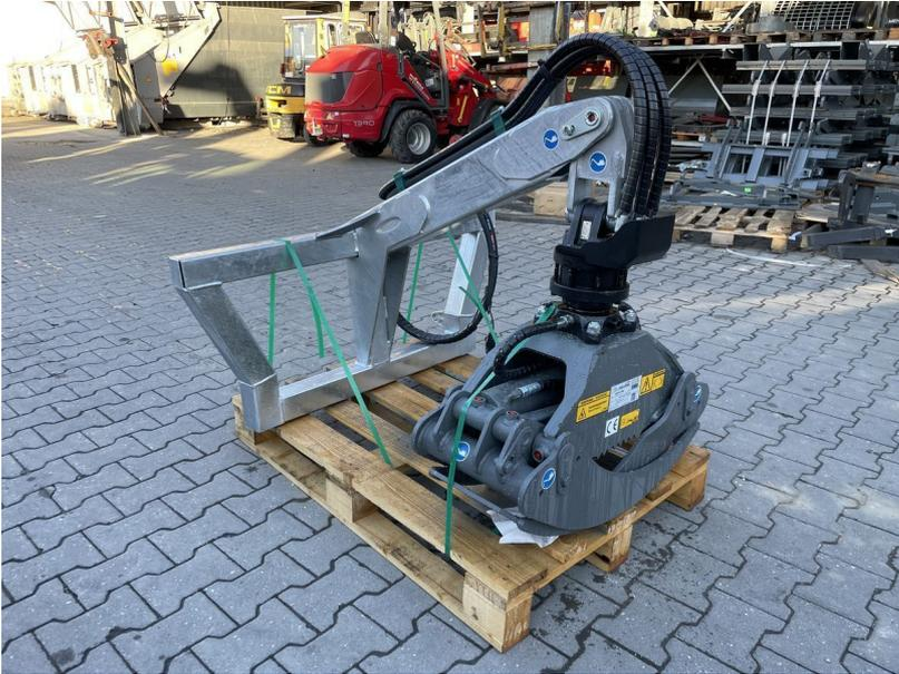
Robuste Holzzange mit 4,5 Tonnen Rotator
