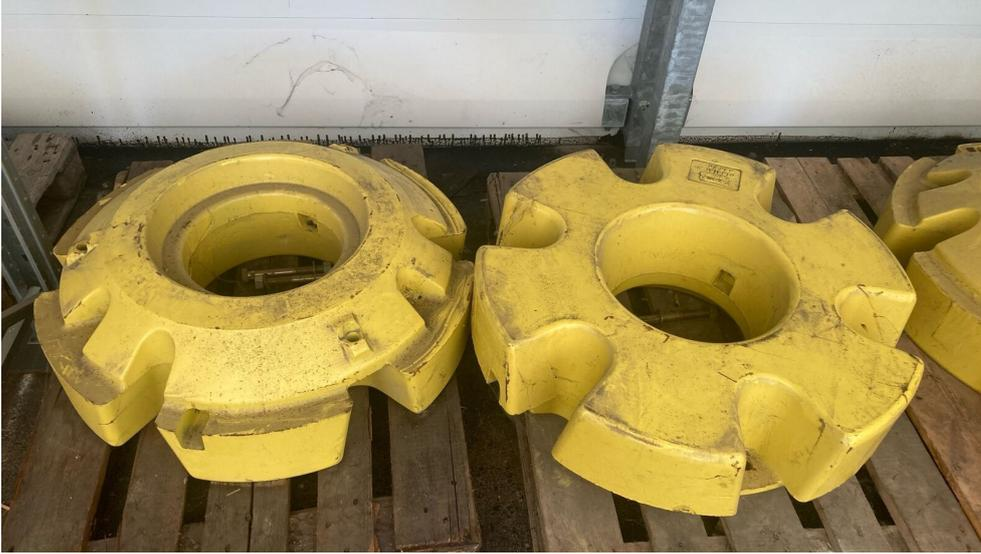
Klassifizierung: Gebrauchtmachine; Maschinentyp: Traktor; Hersteller und Baureihe der passenden Maschine: John Deere 7R 8R; Anzahl der Räder/Reifen: 2; Felgentyp: Fest ; Weitere Maschinenmerkmale: John Deere Radgewichte
