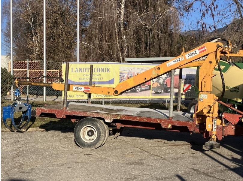
Forstanhänger mit starken Rahmen und geschlossene Ladefläche (Plateau) mit Stahlboden, 2 Rungenpaare, Beleuchtung, Zwillings-Bereifung, Penzkran 6,7 m mit Teleskopausschub, Hochsitz, Hubkraft bei 4 m Reichweite 1400 kg, Schwenkwerk mit 2 Zylinder, Versorgung über Eigenölversorgung, Endlosrotator mit Pendelbremse, hydraulische Holzzange, Flapdown-Abstützung, einsatzbereit, prompt verfügbar.
