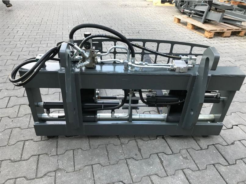
Hydraulische Palettengabel / Staplergabel / Zinkenverstellgerät mit hydraulischer Zinkenverstellung.
