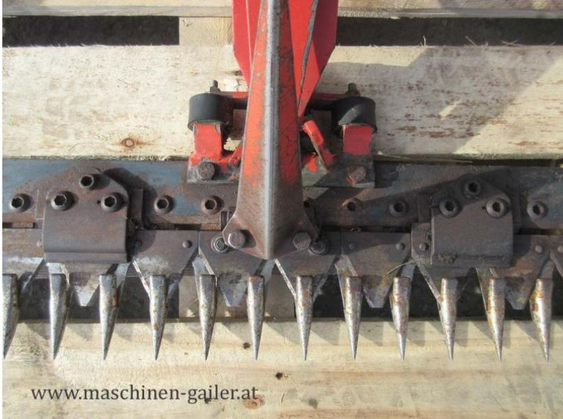
Der Balken ist passend zu einem Moty Motormäher Pony II. Er hat eine Arbeitsbreite von ca. 140cm. Der Balken ist einsatzbereit.
