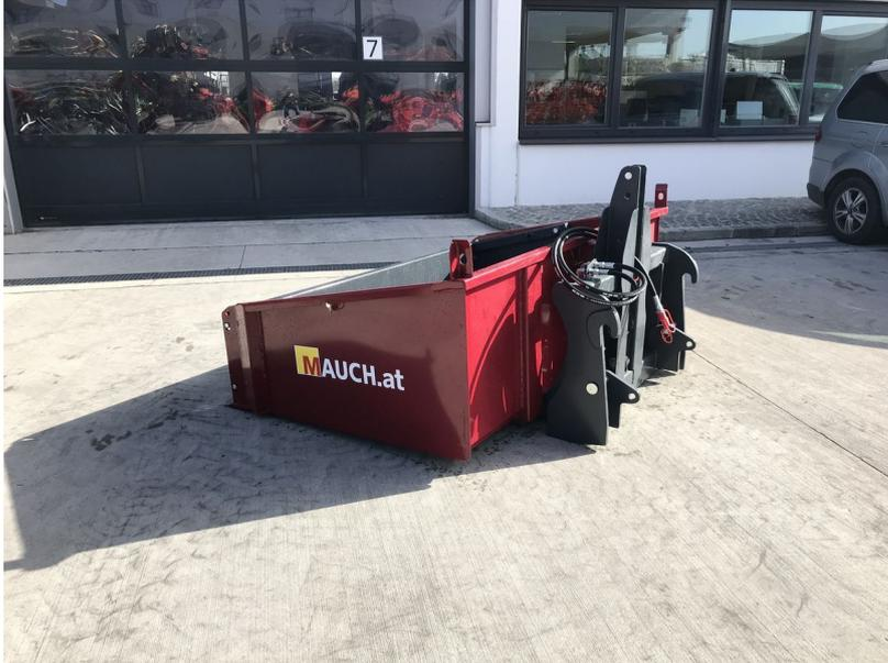
Mauch Kippmulde 2000x600x1100, 520kg, zwei Zylinder, Schiene aus Hardox, doppelte Aufnahme (Euro + Dreipunkt)
