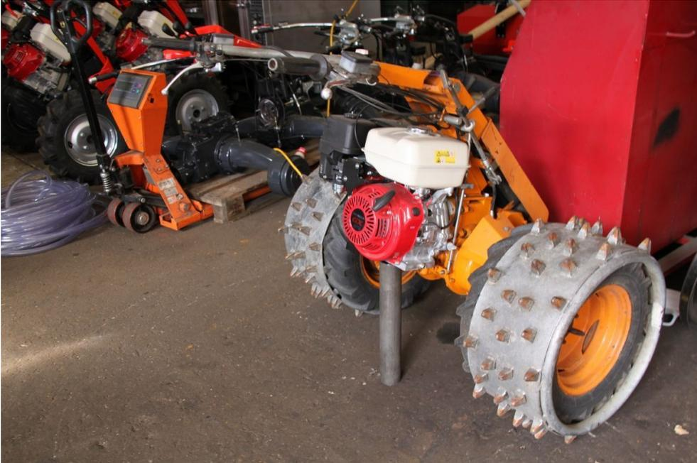
Wir bieten einen Motor Umbauservice von allen gängigen Motormähern (Reform M12, Jet 1/2/3 Hydro uvm.) auf einen Honda Motor an. Tauschmotor ist ein Honda GX270/390 mit Benzinpumpe und angepasster Motorentlüftung. Perfekt geeignet für den Steilhang-Einsatz! Fragen Sie einfach an.
