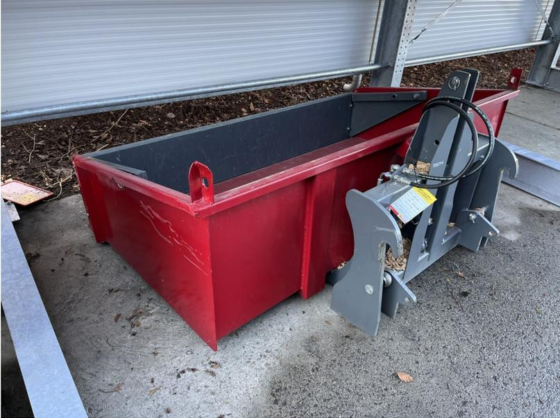
Mauch Kippmulde 2200x600x1100, 540kg, zwei Zylinder, Schiene aus Hardox, doppelte Aufnahme (Euro + Dreipunkt).
