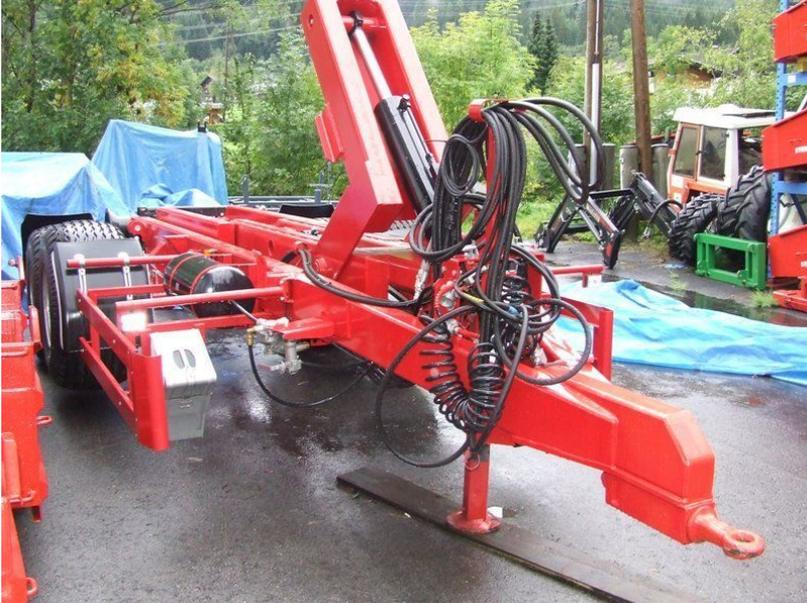
Ausstellungsgerät, ges. Gewicht 15000kg, hydr. Stützfuß, hydr. Containerverriegelung, 40 km/h ADR Achsen, Kotflügel vorne und hinten aus Kunststoff, Werkzeugkiste aus Kunststoff, hydraulische Bremse, Tandem, hydraulischer Stützfuß;
