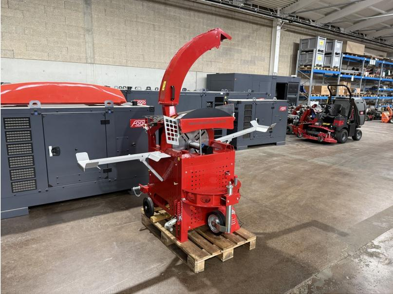
Die AMR EKO P Entrindungsmaschine mit Anspitzvorrichtung und Zapfwellenantrieb ermöglicht die effiziente Aufwertung von Schwachholz mit Durchmessern von Ø 40 bis 250 mm. Mit dieser Maschine können das Ent-rinden, das Spitzten und das Fasen in einem Schritt erledigt werden. Das entrindete Holz zeichnet sich durch eine hohe Qualität aus und ist hervorragend und lange lagerfähig.
