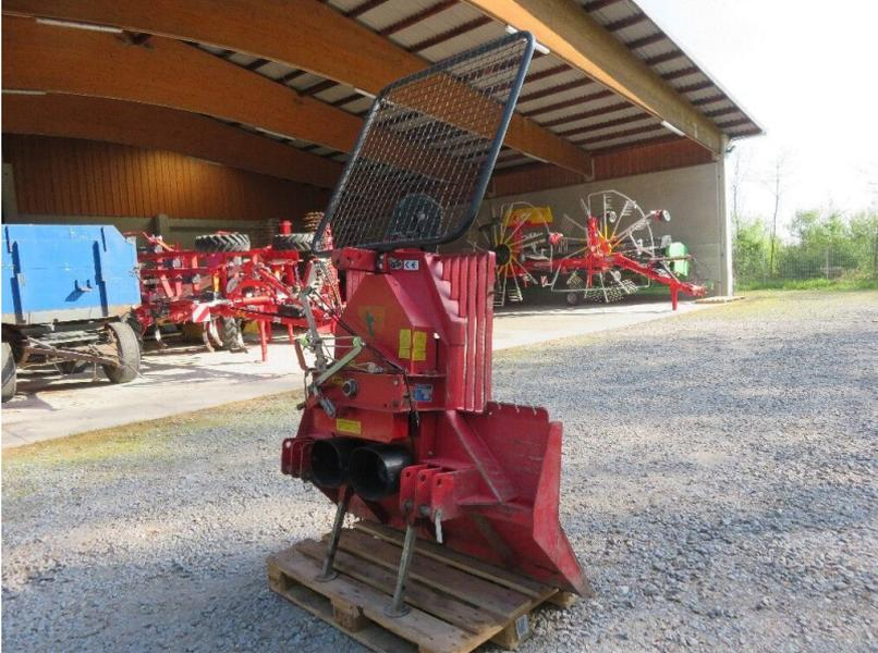
Untersetzungsgetriebe, 100m/10mm Seil, OHNE Gelenkwelle
