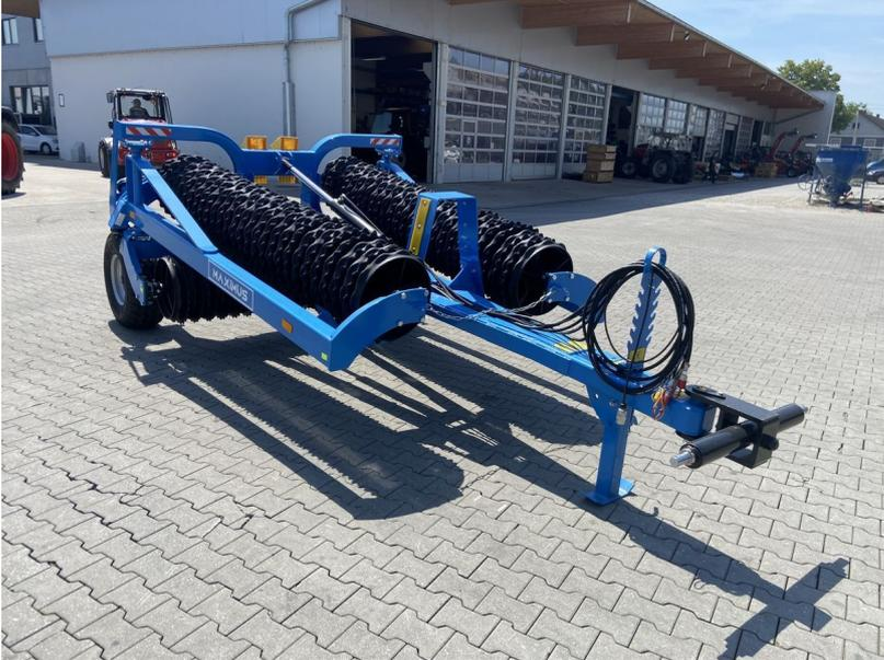
Cambridge Walze auf Fahrwerk, Beleuchtung, 3700 kg, 530 mm Durchmesser, 3 Zylinder.
