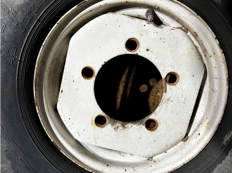
Bucher Ersatzräder, Reifenzustand 10-20%, Bei einer Felge sind die Befestigungslöcher ausgeschlagen, die anderen sind in Ordnung.
