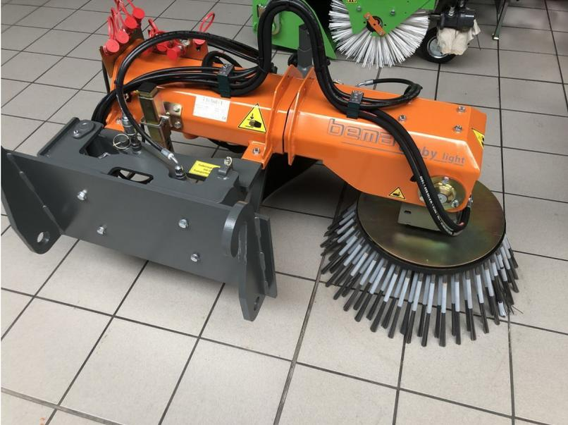
Bema Groby/ Groby Light Unkraut- oder Wildkrautbürste, Mechanische Unkrautbekämpfung ohne Spritzmittel, verschiedenste Anbauten für jedes Trägerfahrzeug stehen zur Auswahl, verschiedene Bürsten wie Stahlflachdraht, Mischbesatz oder PPN stehen zur Auswahl. Kann auch als Futterschieber in Kombination mit dem PPN Besatz verwendet werden.
