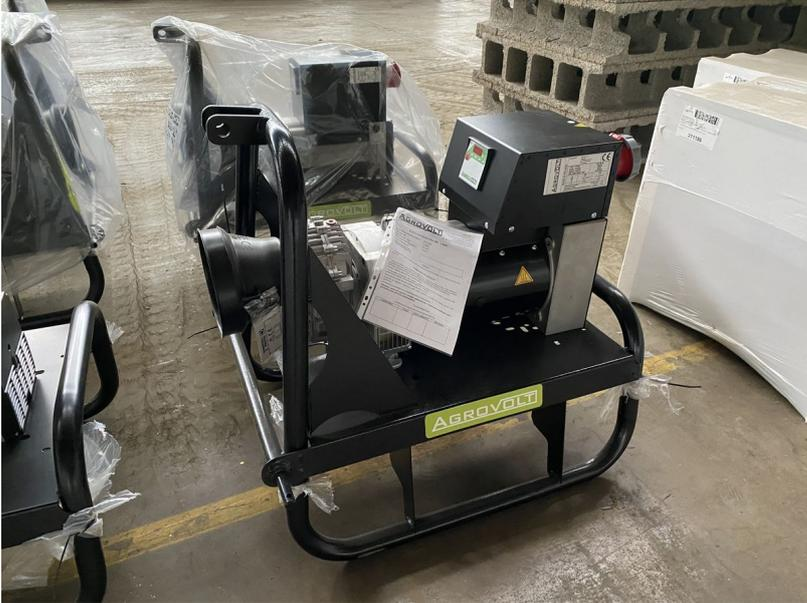
Dieser Zapfwellengenerator ist mit AVR Regelung und digitaler Anzeige ausgestattet.
