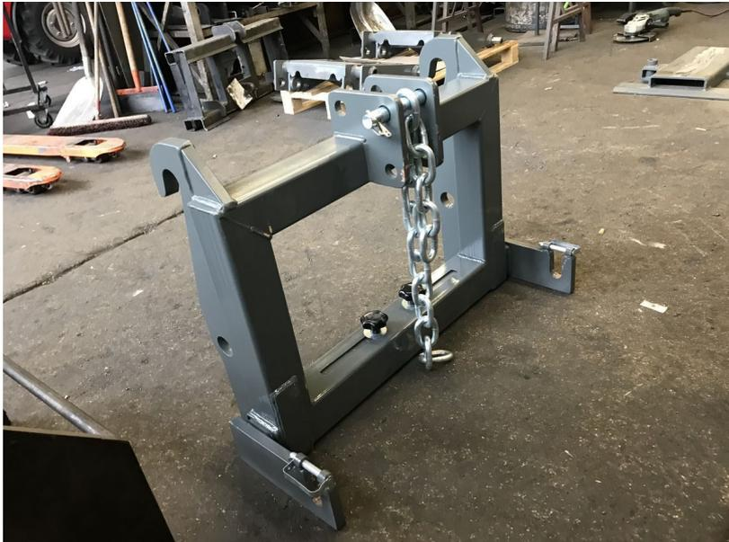
Adapter mit Weidemann hydraulischer Verriegelung auf Dreipunkt Kat 2. Der Adapter ist seitlich verstellbar, sodass alle Dreipunktgeräte Manipuliert werden können.
