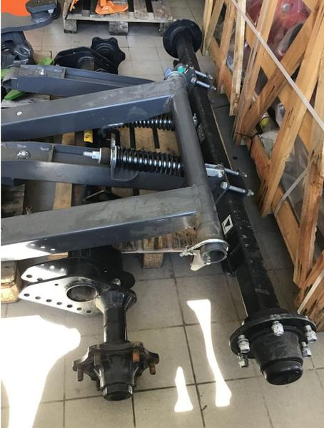
2 Achsen von Rundballenpressen mit 200cm Spurbreite und 6 Loch ungebremst,
