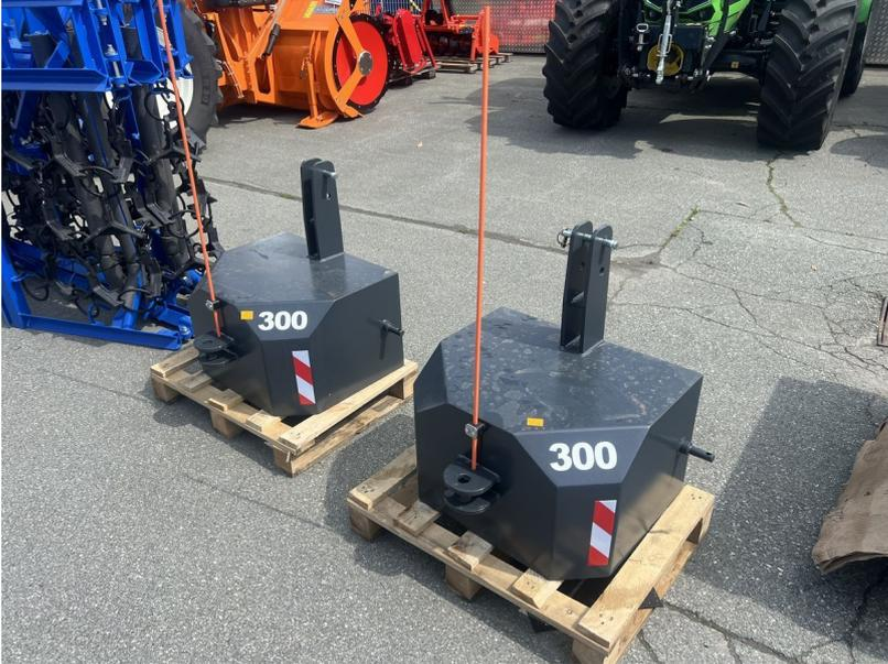
Front-Heckgewicht mit 300 kg, Unterlenkerzapfen Kat 1, Anhängervorrichtung.
