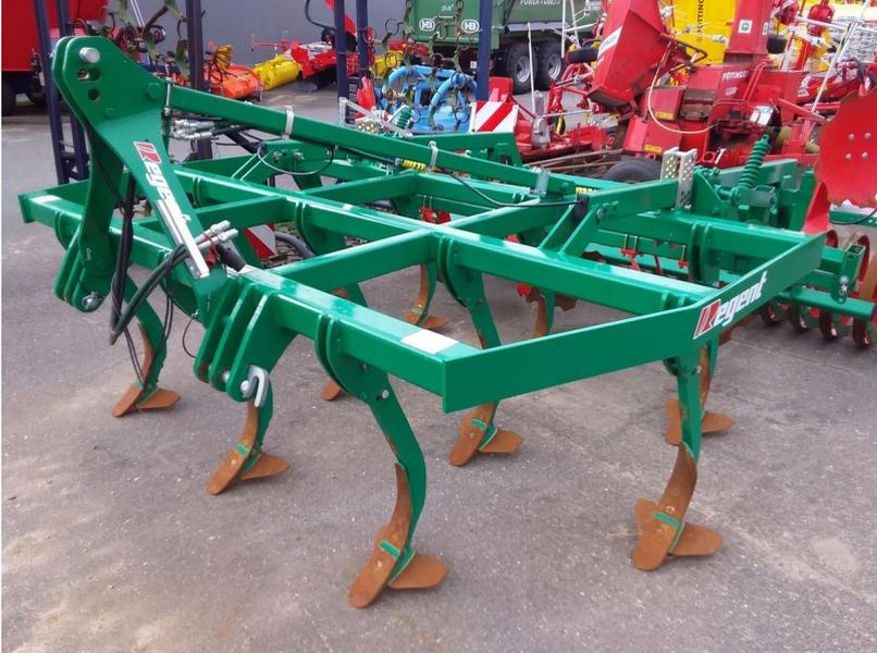
Vorführmaschine, Schneidringwalze, hydr. Tiefenverstellung, Beleuchtung,
