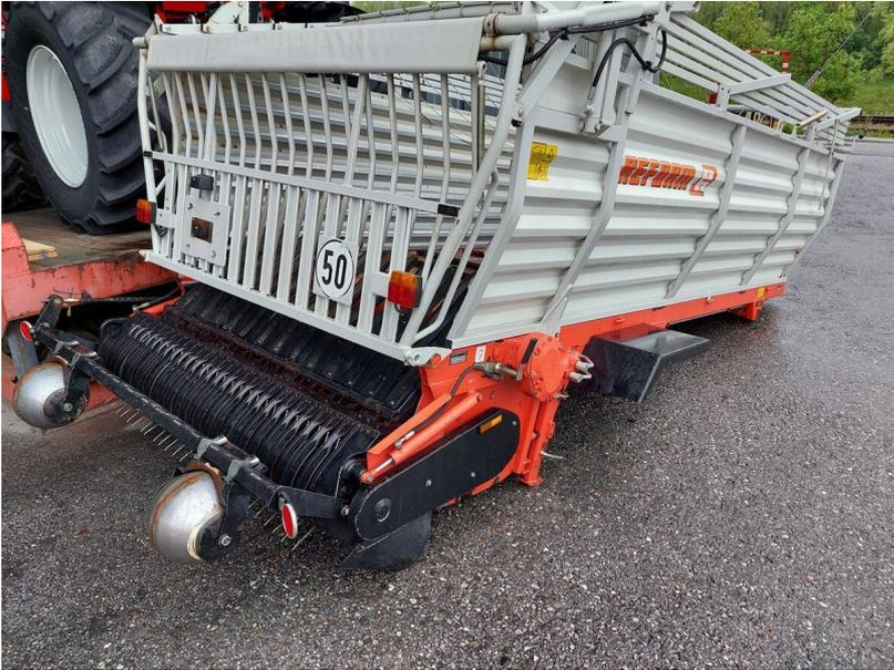
Das Förderaggregat ist mit bis zu 12 Messern bestückbar. Die Schnittlänge beträgt dabei 110 mm. Die drei mittig versetzten Förderschwingen ergeben dabei eine 12-phasige Schnittfolge. Das macht sich unter anderem am ruhigen und runden Lauf bei geringem Kraftbedarf bemerkbar.
