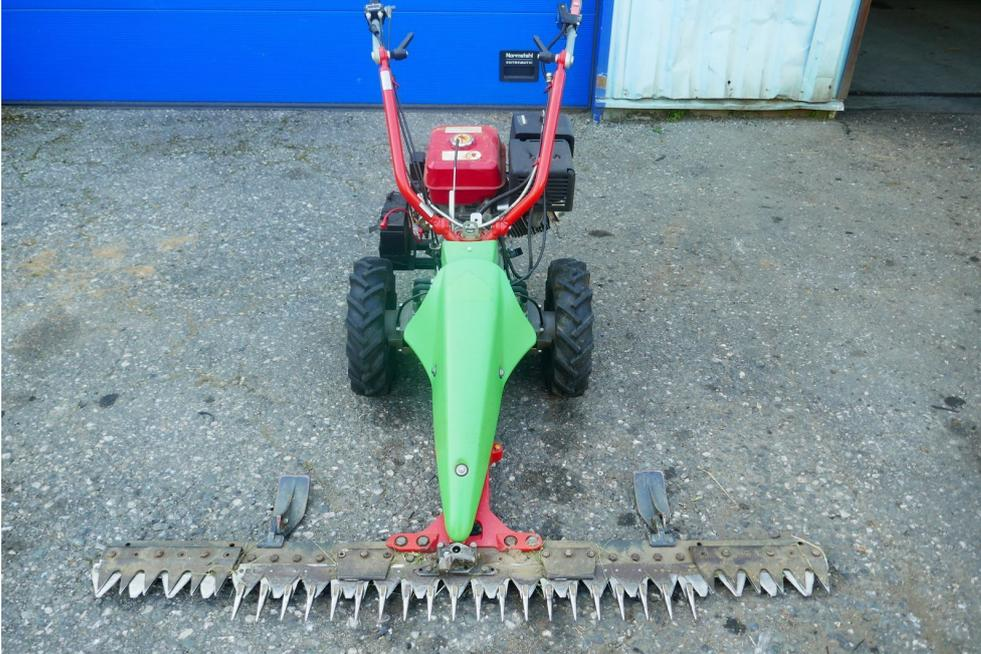
Rapid Rex Hydromotormäher mit 4 Takt Honda Motor, Gummibereifung, 1,70 m Freischnittbalken mit 2 Gleitsohlen, betriebsbereiter Zustand, Standort: Lieserbrücke, prompt verfügbar.
