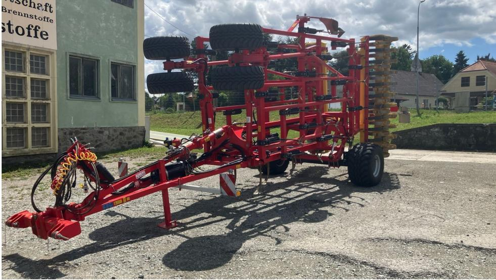
Klassifizierung: Vorführmaschine; Arbeitsbreite: 6; Art der Tiefeneinstellung: Hydraulisch; Klappvorrichtung: Ja; Typ Steinsicherung : SPRING; Transportstützrad: Ja; Walze : Ja; Walzentyp: Doppelwalze
