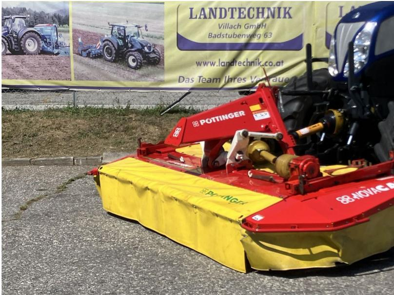
Pöttinger Novacat 306 F, Frontscheibenmäherwerk mit beweglichem Dreipunktbock, Klingenschnellwechsel, Entlastungsfedern, klappbare Seitendeckel, Weistedreieck, Gelenkwelle, Werkstatt geprüft und gepflegter Zustand, prompt verfügbar.
