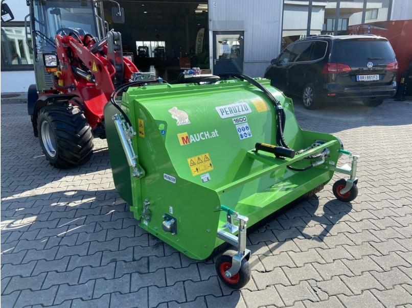
Peruzzo 1600mm, Aufsammelschlegelmäher, ab einer Breite von 1200mm erhältlich.
