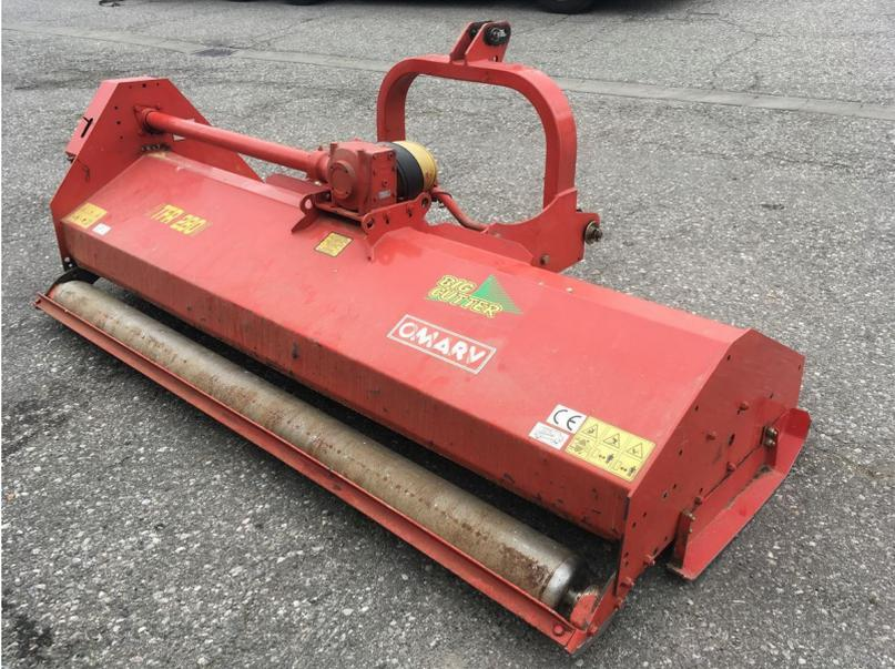
Omarv Heckmulcher 2,8 m Arbeitsbreite, mit Hammerschlegel, Gleitkufen, Stützwalze, Gelenkwelle, betriebsbereiter Zustand, sofort verfügbar.
