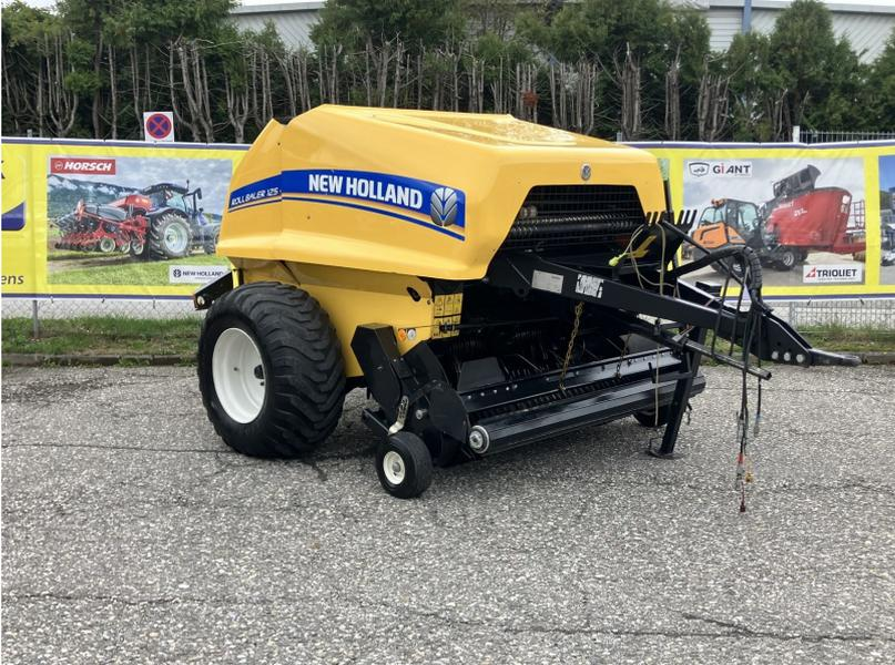
New Holland Rundballenpresse Roll Baler 125, Festkammerpresse mit 15 Messer Schneidwerk, speziell für Silage Produktion (Walzenausführung), Netzbindung, Zentralschmierung, Weitwinkelgelenkwelle, Ballonbereifung: 500/60-22,5, Komfortbedienung ist nicht in Ordnung, (reperatur bedürftig), prompt Verfügbar.
