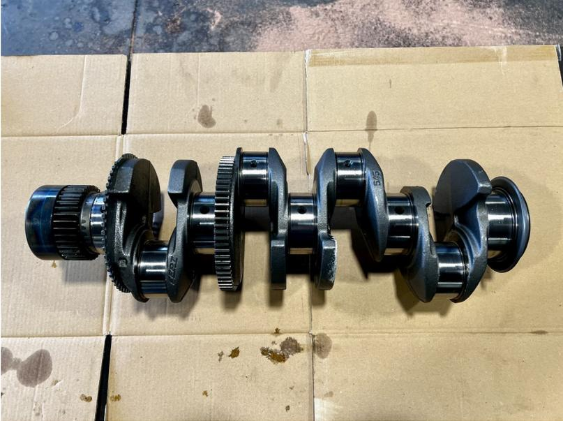
Gebrauchteile von FPT-Motor F5GFL413 mit ca. 600 Betriebsstunden aus New Holland T5.100 EC Baujahr 2018
