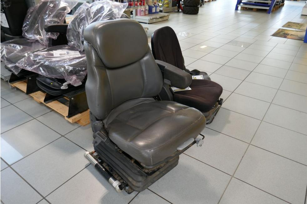
New Holland Fahrersitz, Luftfederung, Höhenverstellung per Kippschalter, passend zu T6 und T7 Modellen mit SideWinder Armlehne, prompt verfügbar
