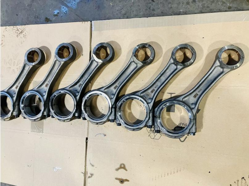
Die Teile stammen aus einem FPT-Motor mit Stirnräderschaden - New Holland T7 mit 6,7L Hubraum
