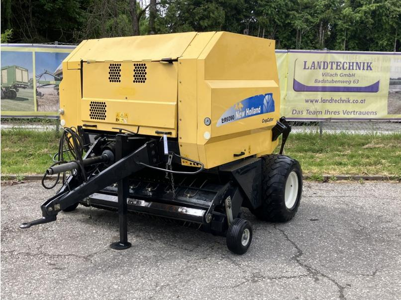
New Holland Rundballenpresse BR 6090, Festkammerpresse mit 15 Messer Schneidwerk, Netzbindung, Zentralschmierung, Weitwinkelgelenkwelle, Bereifung: 19.0/45-17, Komfortbedienung, Rollboden in Ordnung, (Pickup und rund herum Reparaturbedürftig), prompt verfügbar.
