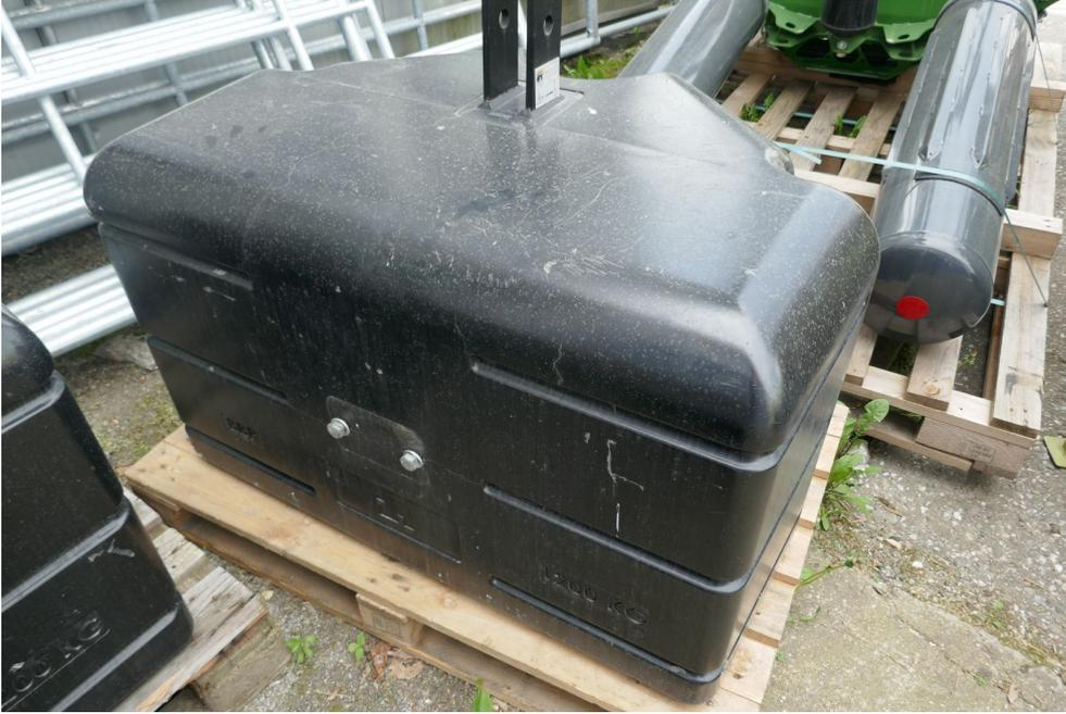
Front und Heckgewicht 1200 kg mit Dreipunktaufnahme, Vorführgewicht, ab Lager Villach, prompt verfügbar.
