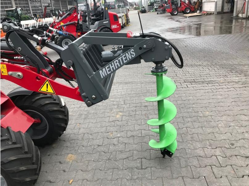
Mehrtens Erdbohrer mit hydraulischen Antrieb
