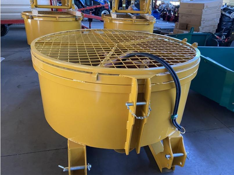
Dieser Selbstlade - Mischer hat einen Trommeldurchmesser von 1500 mm und eine Füllmenge von 750 Litern.
