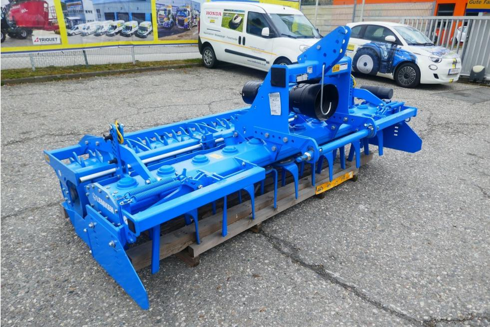
Lemken Kreiselegge Zirkon 8 mit Zahnpackerwalze D550, Dreipunkt Turm schwere Ausführung, Unterlenker KAT 2, Planierbalken hinten, Seitenschild + Seitenblech Verlängerung, Gelenkwelle mit Nockenschaltkupplung, Ausstellzugmaschine, prompt verfügbar.
